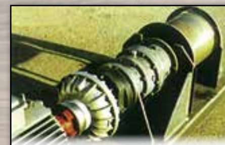
Подъемная лебедка с гидравлической муфтой Lifting winch with hydraulic coupling
