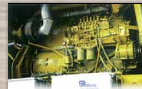
Дизельный двигатель с гидравлической муфтой, монтажный на дробилке Diesel engine with hydraulic coupling for crusher
