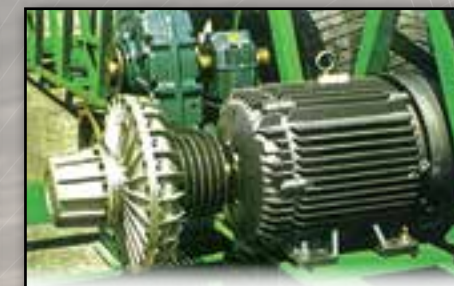
Гидравлическая муфта на ленточном конвейере Hydraulic coupling on belt conveyor
