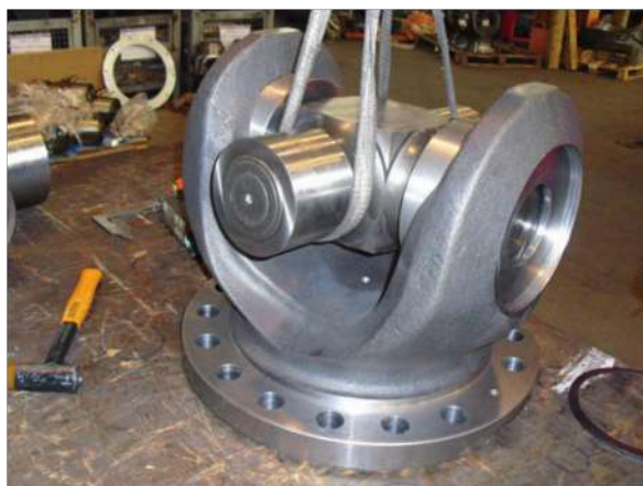
Montaggio giunto 490 490 Joint assembling
