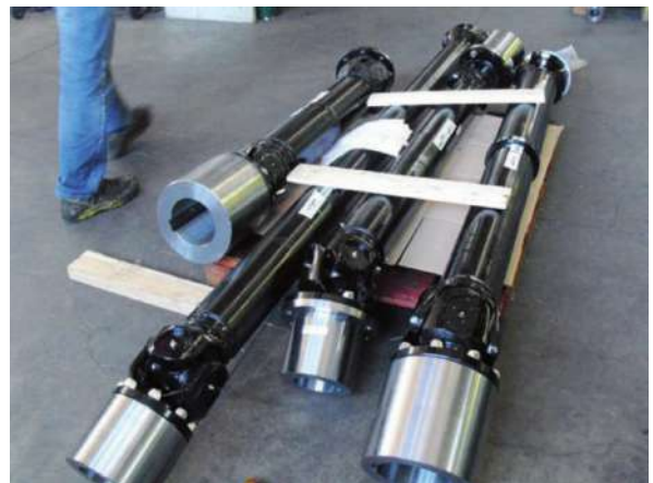
Cardani serie DNFx completi di mozzi Universal shafts / Companion flanges
